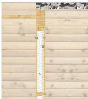
sezione orizzontale raccordo muro - pilastro 1:10
