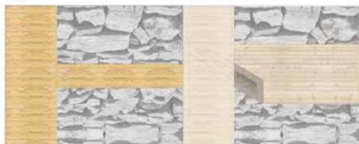
sezione verticale dettaglio incastro panca della sala_lettura 1:5
